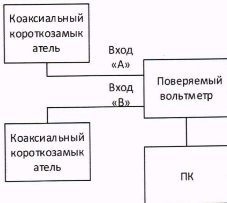
Рисунок 3 – Схема для определения уровня внутренних помех
