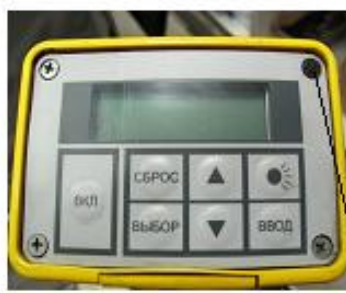
Пломба на крепежный винт корпуса ПЛОТ-3Б-1Р Рисунок 2б
