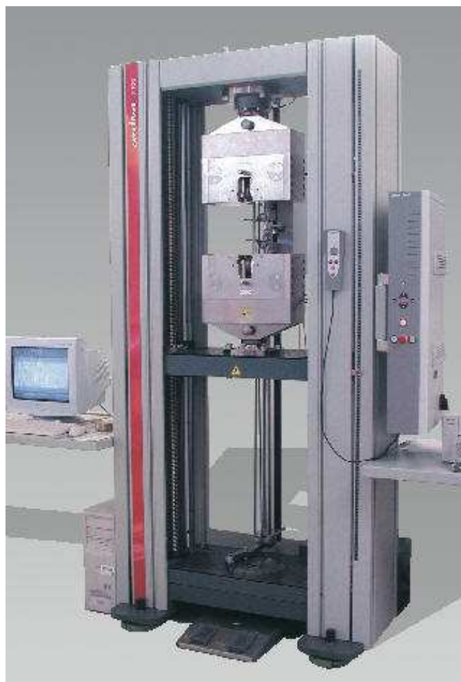
Рисунок 1 Общий вид машины универсальной испытательной серии Z напольного исполнения
