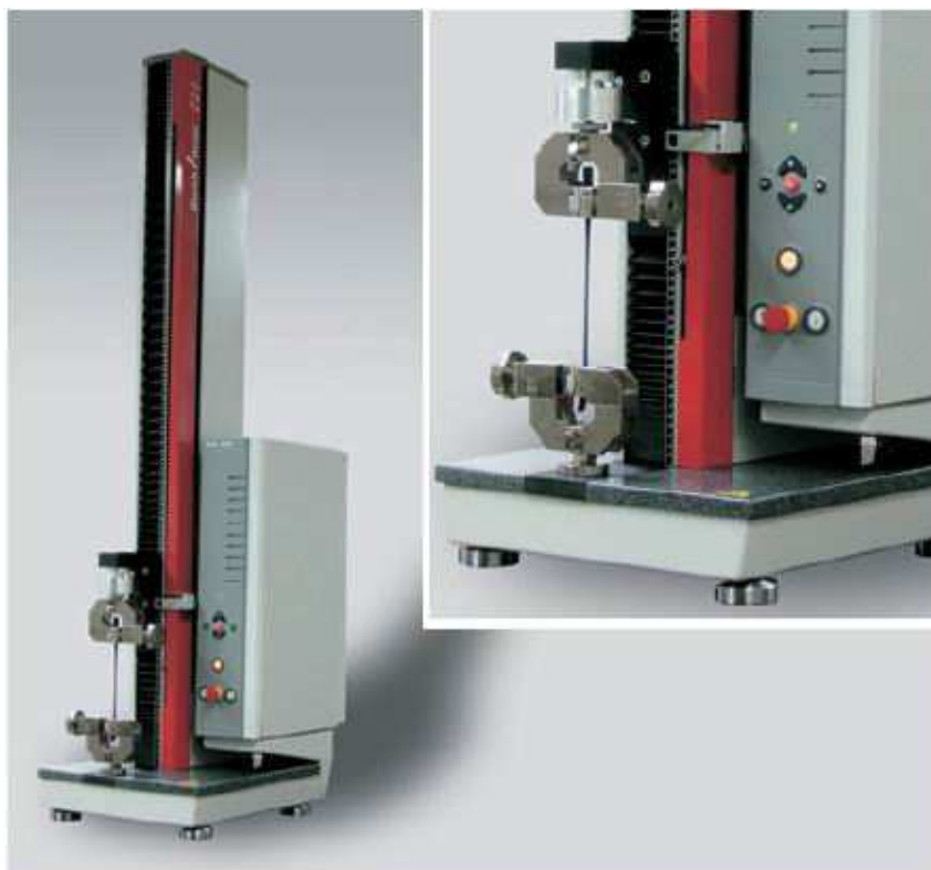
Рисунок 2 Общий вид машины универсальной испытательной серии Z настольного исполнения
