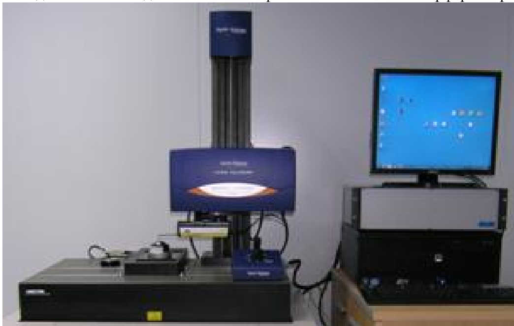
Рисунок 1 - Прибор для измерений текстуры поверхности, отклонения от формы дуги окружности, прямолинейности и радиуса дуги средней линии по методу наименьших квадратов серии FORM TALYSURF
