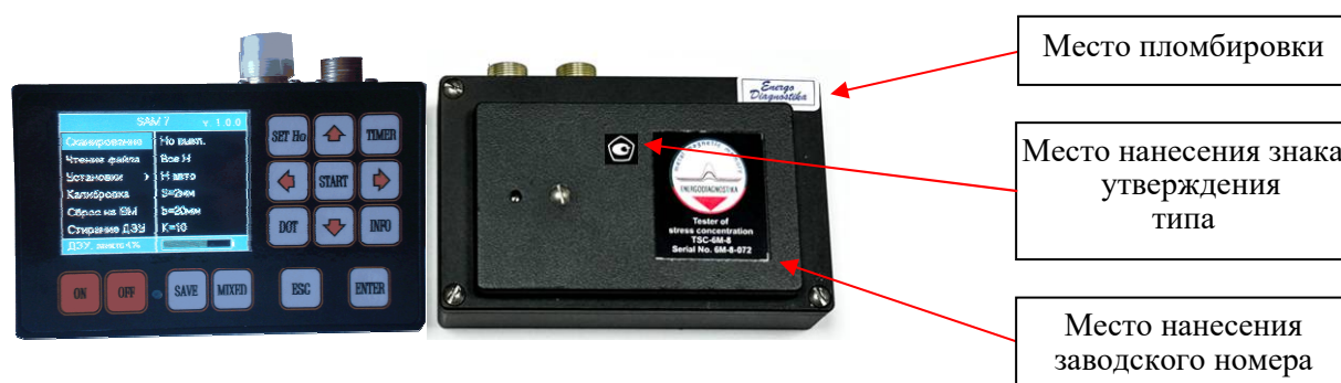
Рисунок 7 – Общий вид прибора модификации ИКН-6М-8, обозначение мест нанесения знака утверждения типа, пломбировки и нанесения заводского номера
