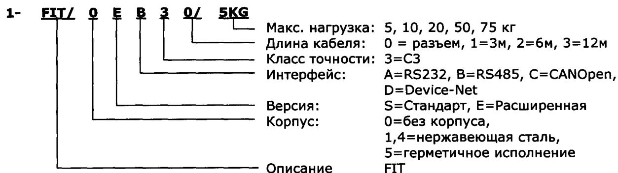
Датчики PW2, PW10, PW18i, PW20i, FIT могут выпускаться в модификациях отличающихся конструкцией корпуса ("H"), стандартным исполнением ("S"), с сервисной функцией задания двух пороговых значений выходного сигнала ("L"), с сервисной функцией дозирования ("D"), с интерфейсом RS 232 ("R2"), интерфейсом RS 485 ("R5").
