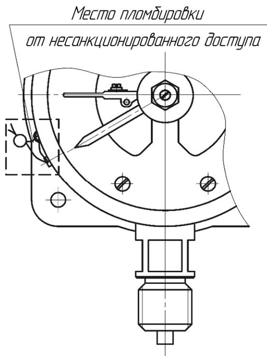
Рисунок 3 - Схема обозначения места пломбировки от несанкционированного доступа
