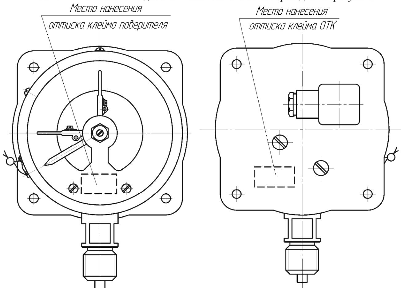
Рисунок 2 - Схема обозначения мест для нанесения оттисков клейм
