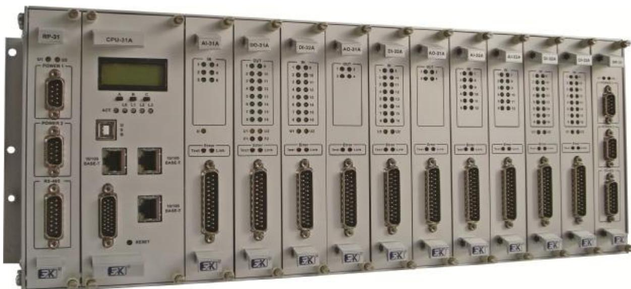
Рисунок 3 Внешний вид модулей серии DCS-2000 в корпусе
