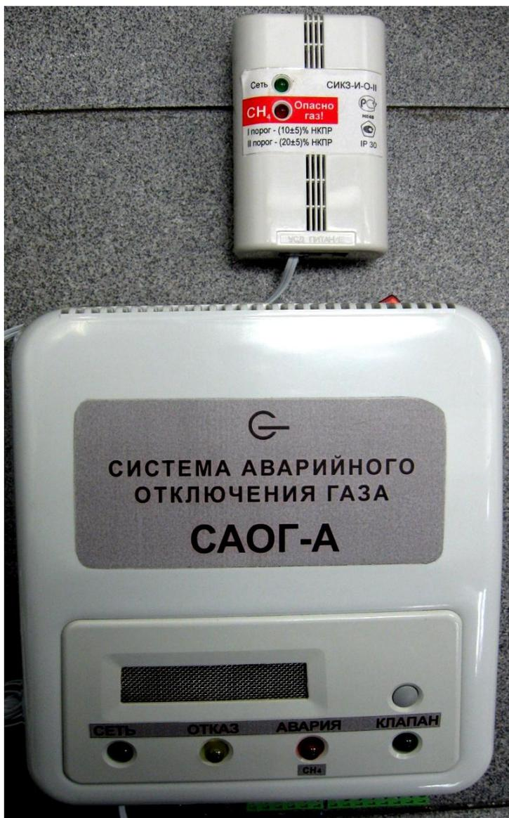
Рисунок 2 - Внешний вид Системы исполнения САОГ-А
