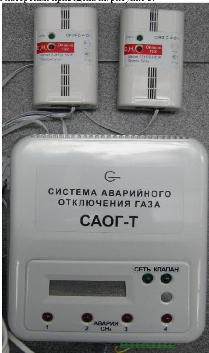
Рисунок 1 – Внешний вид системы исполнения САОГ -Т
