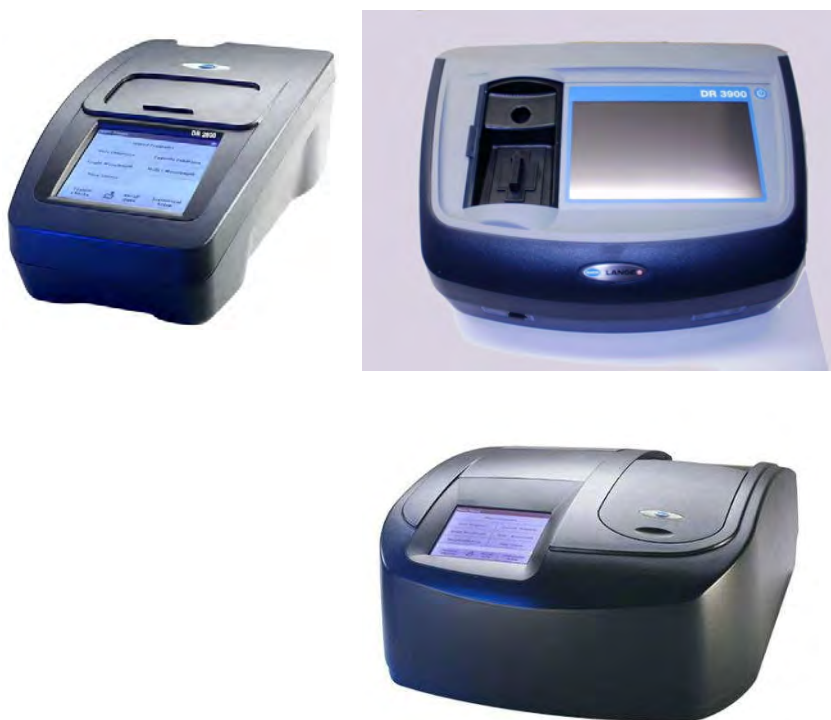
Рисунок 1 Внешний вид спектрофотометров модели DR 2800, 3900, 5000
