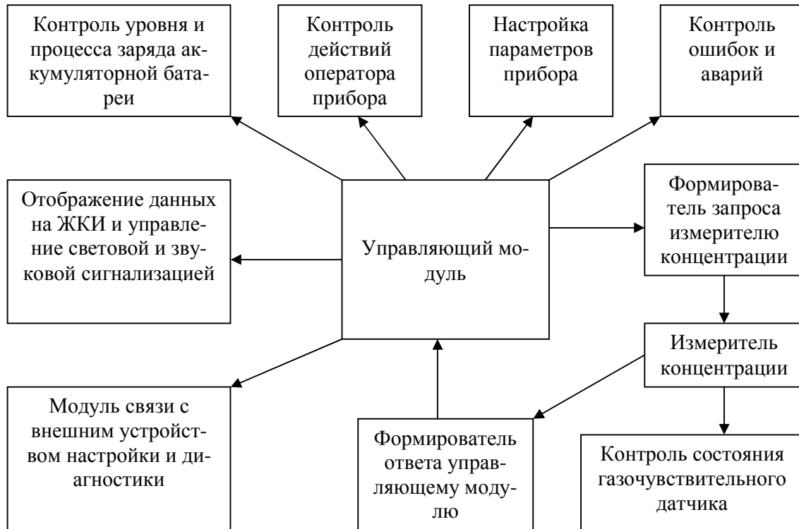
Рисунок 3. Структура ПО газоанализатора ФП11.2к
