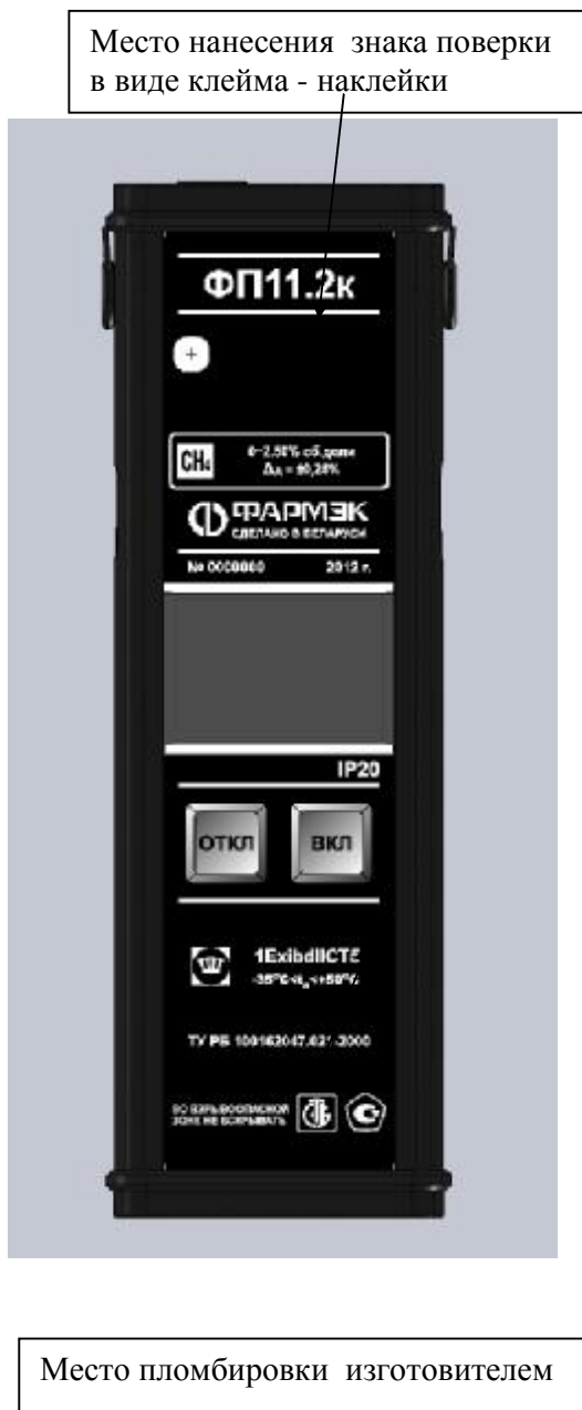
Рисунок 2 - Схема пломбировки для защиты от несанкционированного доступа и обозначение мест для нанесения оттисков клейм.
