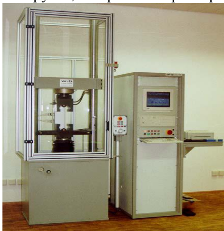
Рисунок 1. Общий вид машины универсальной испытательной LF с двумя направляющими колоннами.
