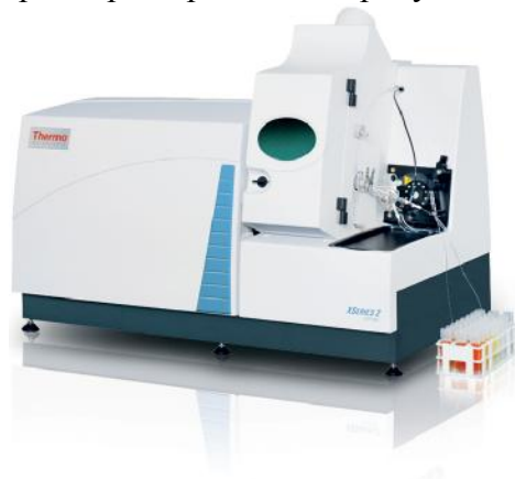
Рис. 1. Масс-спектрометры с индуктивно-связанной плазмой XSERIES 2.
