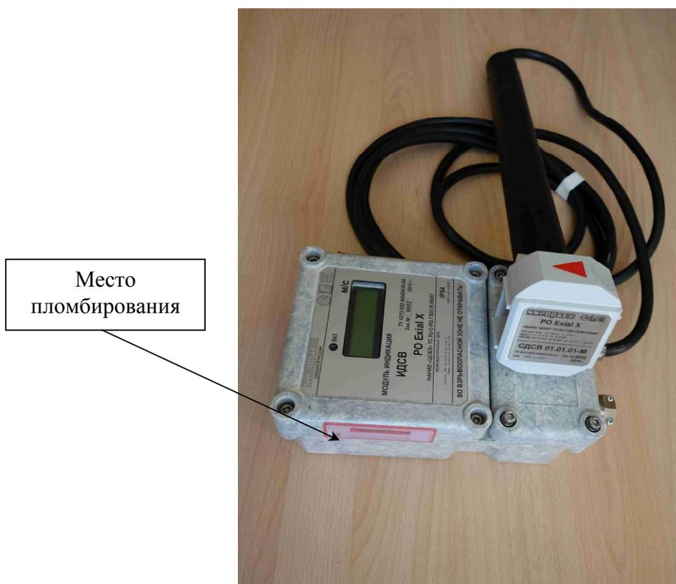
Рисунок 2 - Общий вид измерителя модификации СДСВ 01.YY.XX-MZ
