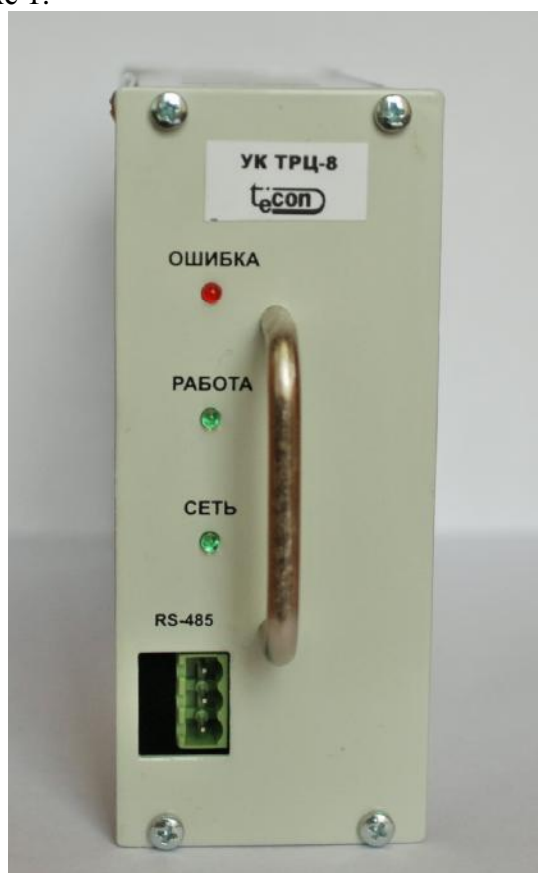
Рисунок 1 - Фото общего вида устройства контроля тональных рельсовых цепей ТРЦ-8
