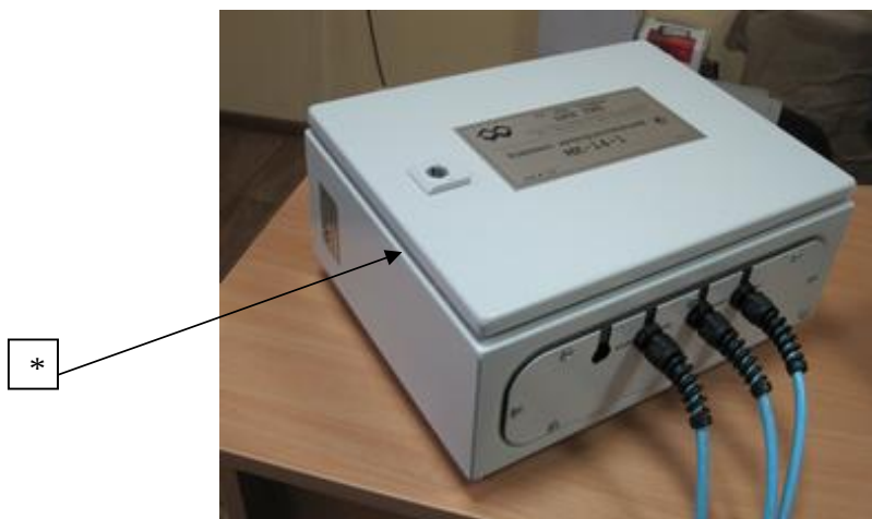
Рисунок 3 - Внешний вид БП и места пломбирования от несанкционированного доступа и нанесения знака утверждения типа
