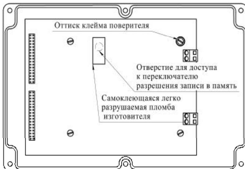
Рисунок 4 – Места пломбирования измерительной платы шестиканального вычислителя.
