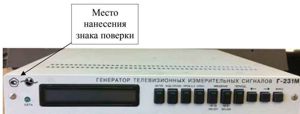
Рисунок 2 – Общий вид генератора в переносном исполнении и обозначение места нанесения знака поверки
