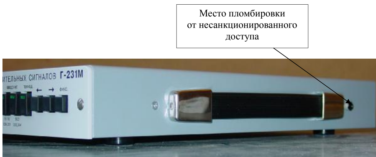
Рисунок 3 – Схема пломбировки генератора от несанкционированного доступа
