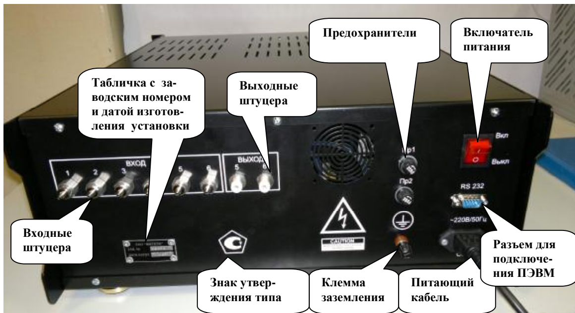
Рисунок 2 - Вид задней панели установки динамической «Микрогаз-Ф»
