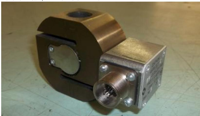
Рис. 1. Общий вид датчиков силоизмерительных тензорезисторных 4508 ДСТ
