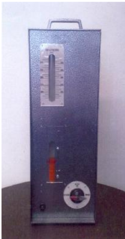
Рисунок 1 – Общий вид измерителя объема ИО-1М
