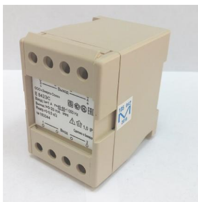
Рисунок 3 – Общий вид преобразователя модификации E 842ЭС (диапазон изменения выходного сигнала от 0 до 20 мА)
