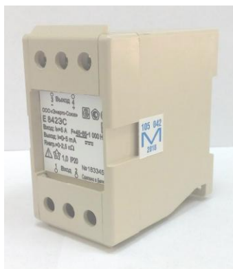
Рисунок 2 – Общий вид преобразователя модификации E 842ЭС (диапазон изменения выходного сигнала от 0 до 5 мА)
