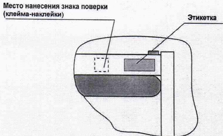
Рисунок 2 – Место нанесения знака поверки (клейма-наклейки)
