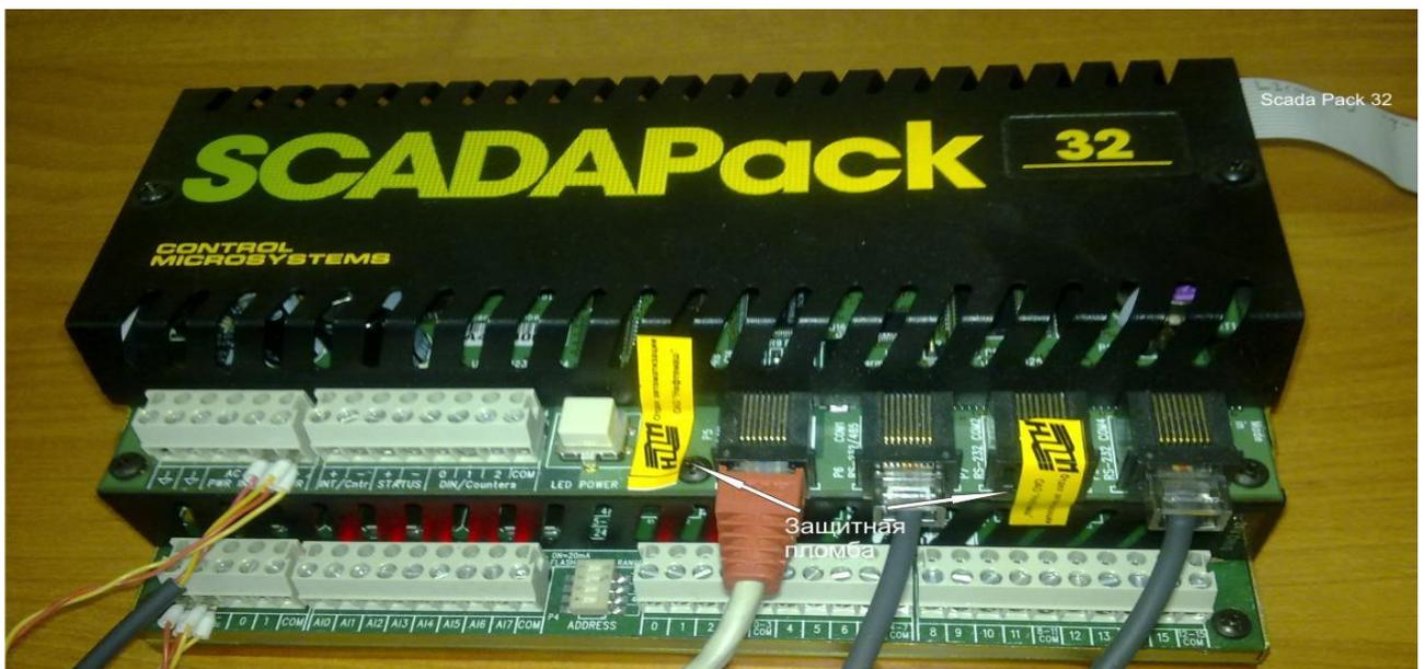
Рисунок 4 - Схема пломбирования контроллера «SCADAPack32»
