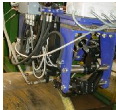
Рисунок 3. Система контроля сварного шва и околошовной зоны.
