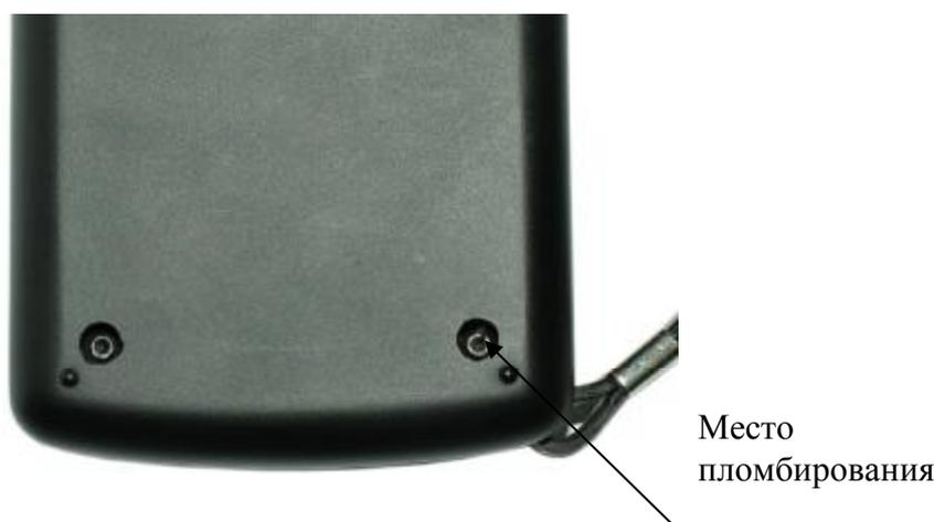
Рисунок 2 - Место пломбирования и клеймения прибора модификации Поиск-2.6
