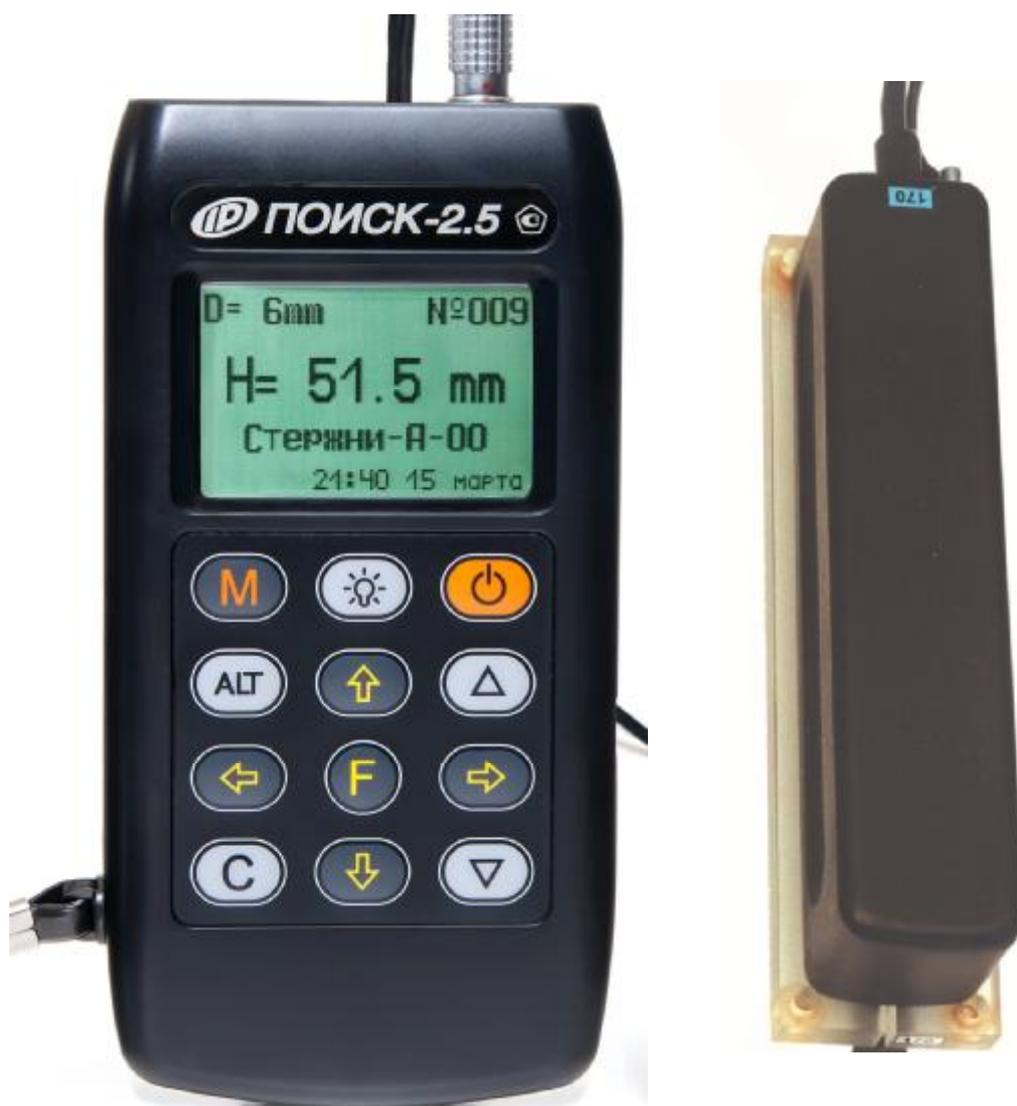
Рисунок 3 – Общий вид прибора модификации Поиск-2.5
