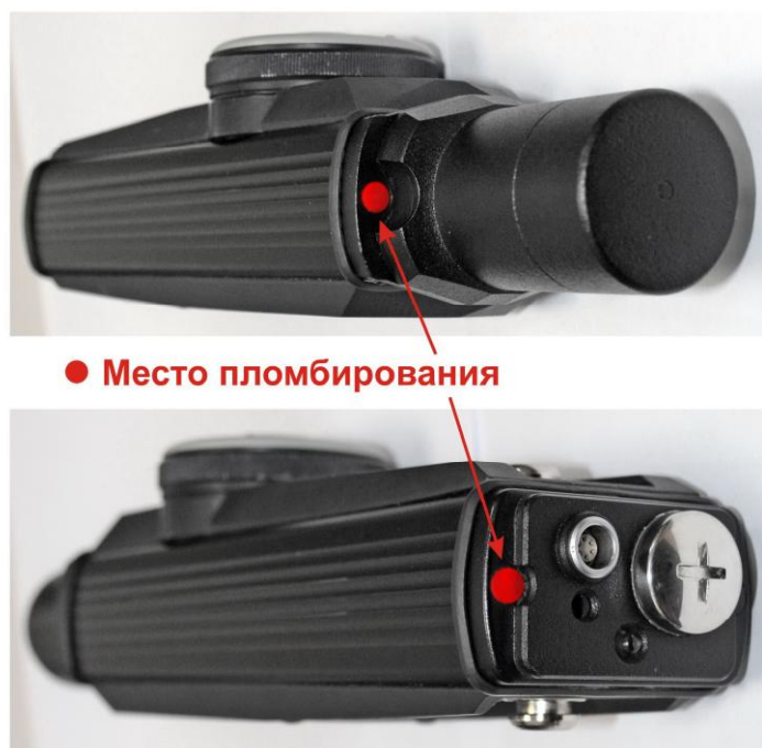
Рисунок 2 - Место пломбирования дозиметров-радиометров поисковых МКС-PM1401К
