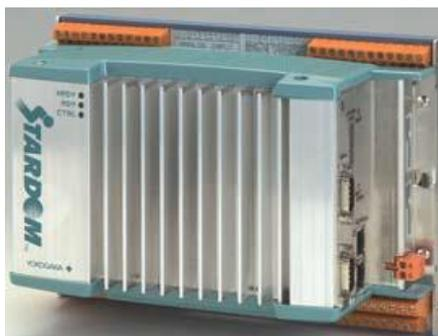
Рисунок 3 – Общий вид комплекса на базе контроллеров FCJ
