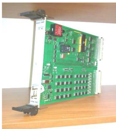
Рисунок 1 - Модуль ввода аналоговых сигналов ВАС-15Р.
