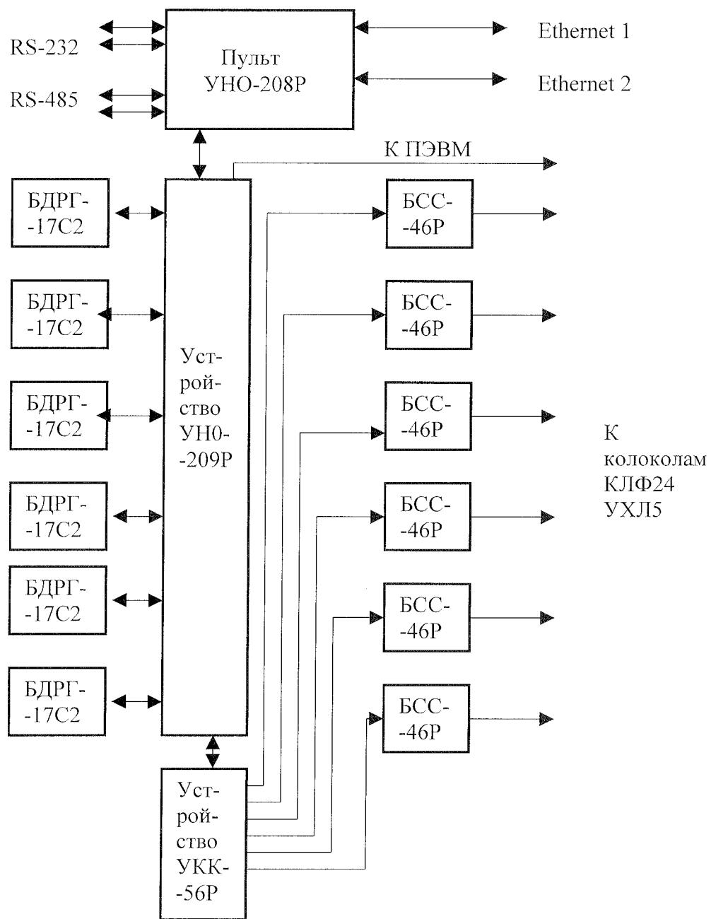
Рисунок 1. Структурная схема системы дозиметрического контроля ДКГ-18Р
