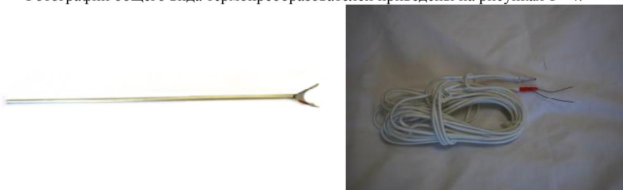
Рисунок 1 - Общий вид бескорпусных ДТП модификации ХХ1
