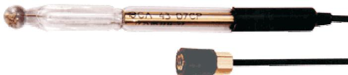
Рисунок 2 – Общий вид электродов стеклянных лабораторных ЭСЛ-43-07СР, ЭСЛ-63-07СР
