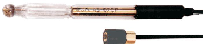
Рисунок 2 – Общий вид электродов стеклянных лабораторных ЭСЛ-43-07СР, ЭСЛ-63-07СР
