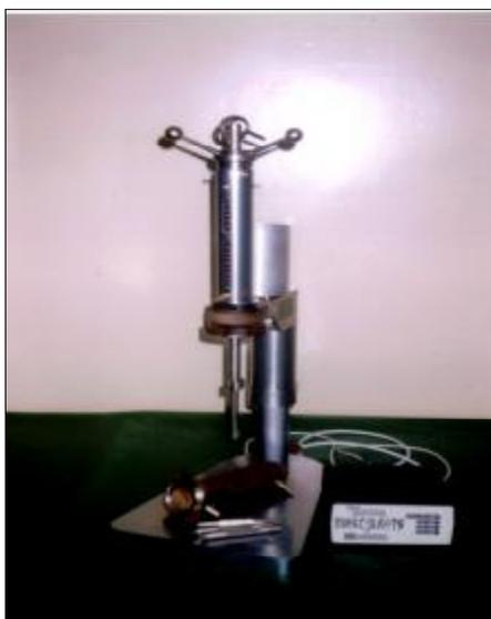
Рис.1 Вид вискозиметра капиллярного автоматического АКВ-2ЖВ
