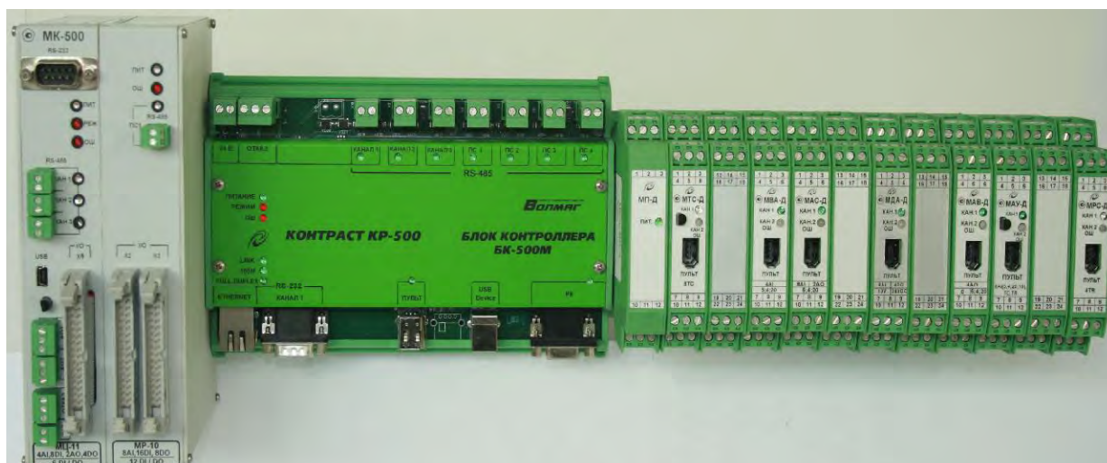
Рисунок 1 Фото общего вида контроллеров многофункциональных KR-500, KR-500M
