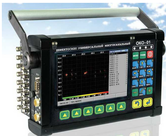
Рисунок 1 – Общий вид дефектоскопа ультразвукового универсального УД4-94-ОКО-01
