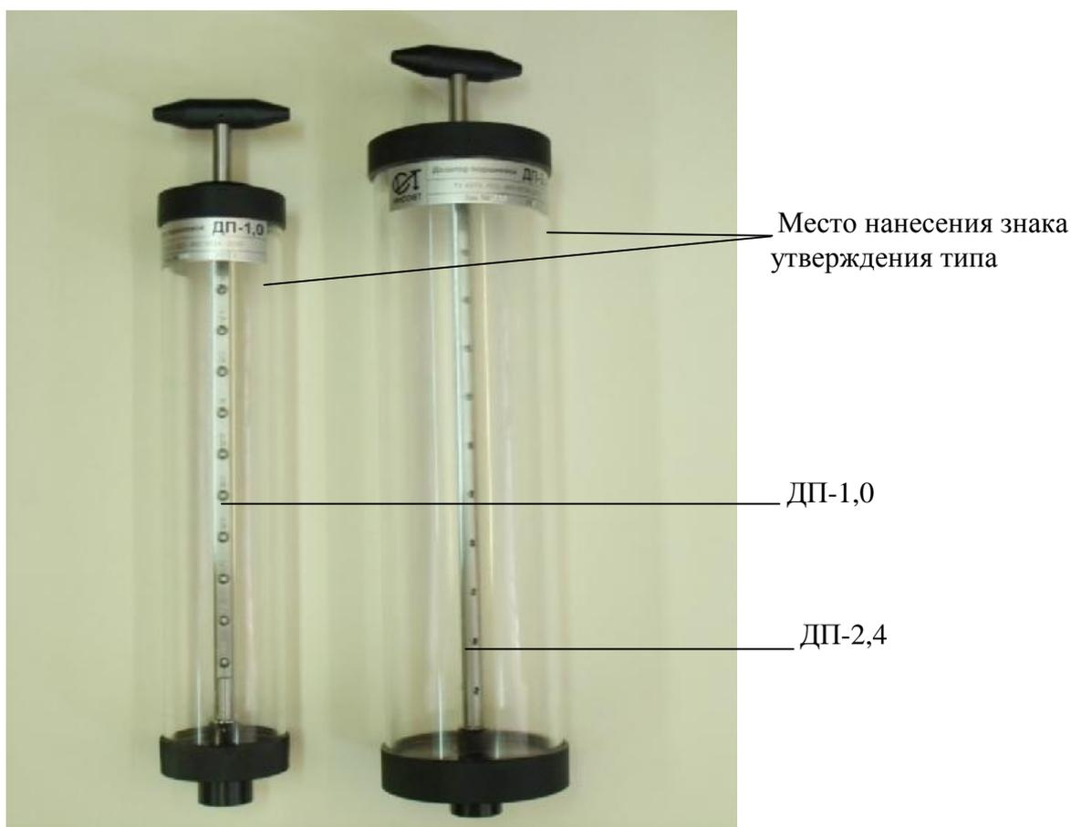
Рисунок 1 - Общий вид дозаторов поршневых: ДП-2,4; ДП-1,0
