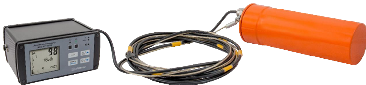
Рисунок 7 – Прибор в составе с БДКГ-01 в гермоконтейнере и БОИ
