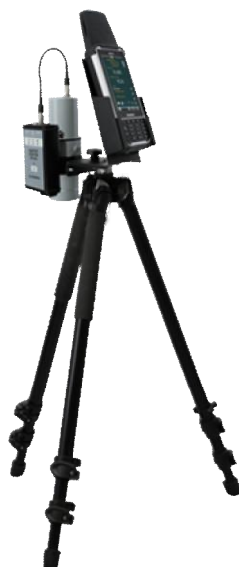
Рисунок 4 – Прибор в составе с БДКГ-30, БОИ4 и адаптером ВТ-DU4 на штативе
