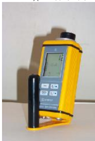
Рис. 1. Внешний вид и место пломбирования дозиметров ДКР-АТ1103М
