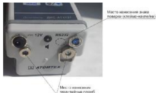
Рис. 1. Внешний вид и место пломбирования дозиметров ДКР-АТ1103М
