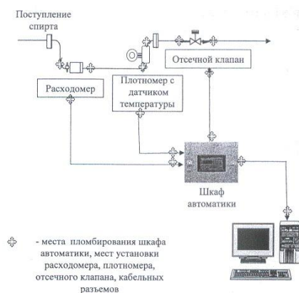
Схема пломбировки КСИП-3С на контроле и учете спирта
