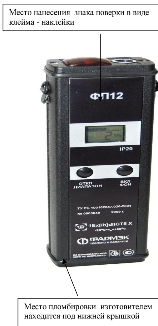
Рисунок 2- Схема пломбировки для защиты от несанкционированного доступа и обозначение мест для нанесения оттисков клейм
