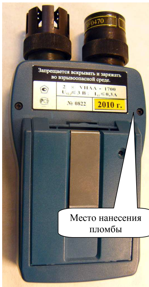
Рисунок 2 – Схема пломбирования газоанализатора от несанкционированного доступа
