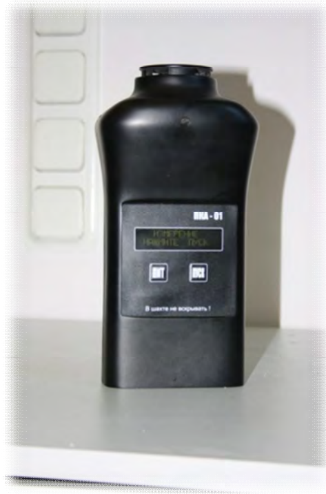
Рис. 1. Внешний вид приборов контроля запыленности воздуха ПКА-01
