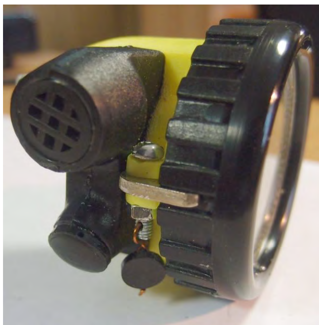
Рисунок 2. Место пломбирования сигнализатора метана, совмещенного со светильником взрывобезопасным головным СВГ «Сигмет»
