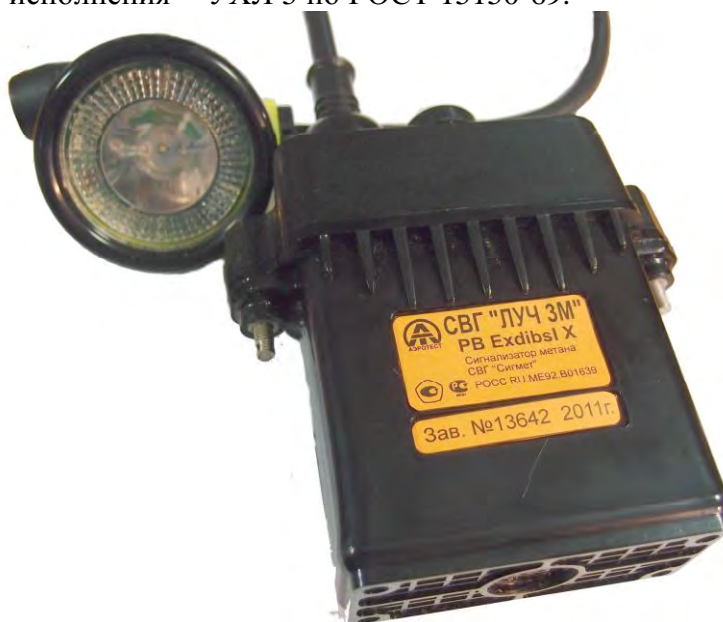
Рисунок 1. Внешний вид сигнализатора метана, совмещенного со светильником взрывобезопасным головным СВГ «Сигмет»
