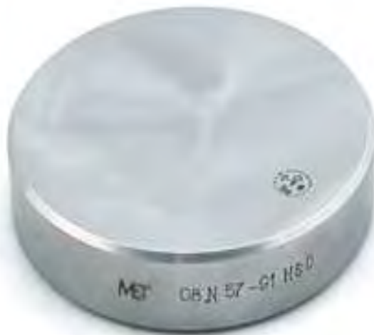
Рис.1 Внешний вид мер твёрдости эталонных Шора МТШ-МЕТ.
