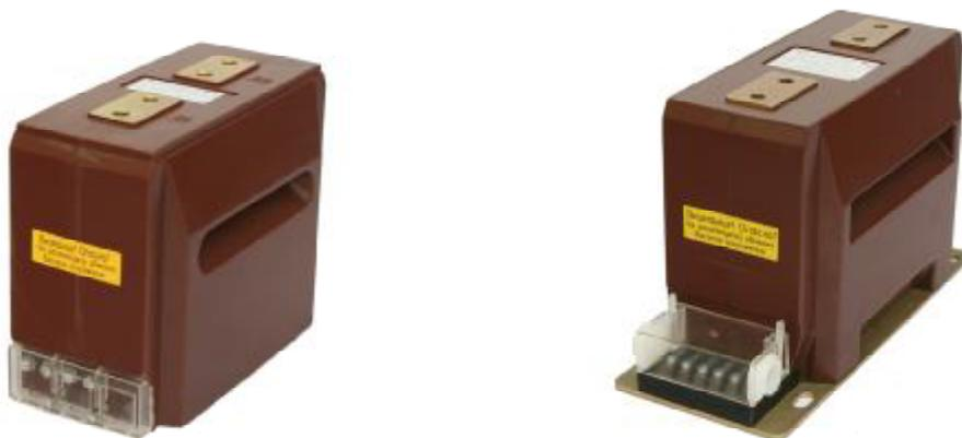
Корпус трансформаторов выполнен из эпоксидного компаунда, который одновременно является главной изоляцией и обеспечивает защиту обмоток от механических и климатических воздействий. Все исполнения трансформаторов тока ТОЛ-СЭЩ-10 изготавливаются как с изолирующими барьерами из эпоксидного компаунда, расположенными в верхней части трансформаторов со стороны первичных выводов, так и без них.
