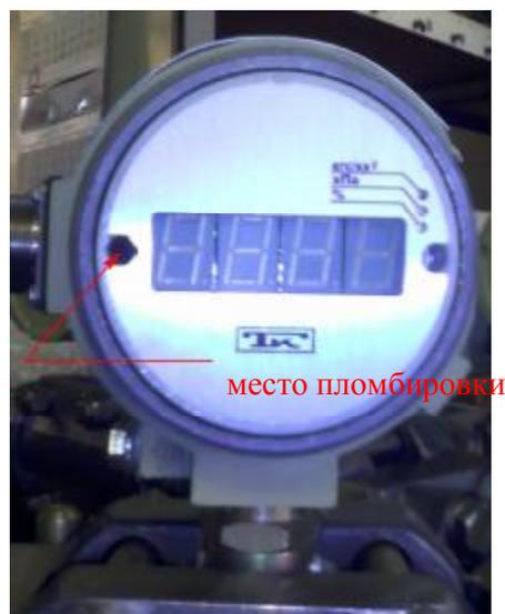
Рисунок 2 - Схема пломбирования
