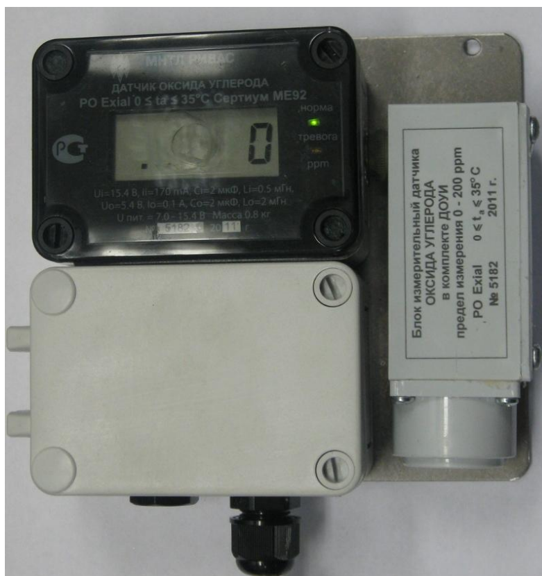
Рисунок 1 – Датчик оксида углерода искробезопасный ДОУИ, внешний вид
