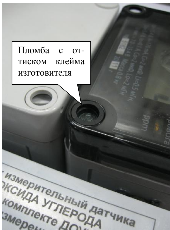
Рисунок 2 – Схема пломбировки от несанкционированного доступа
