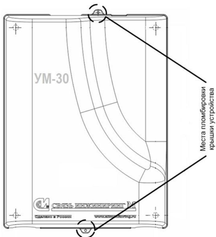
Рисунок 2 - Схема пломбировки устройств мониторинга «УМ-30»
